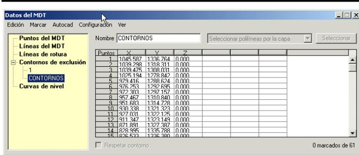
Calculamos de nuevo la triangulación, activando la casilla de "Existe contorno de inclusión" y poniendo como distancia máxima de búsqueda un valor de 500. Con lo que obtengo el siguiente resultado, que es el deseado.
