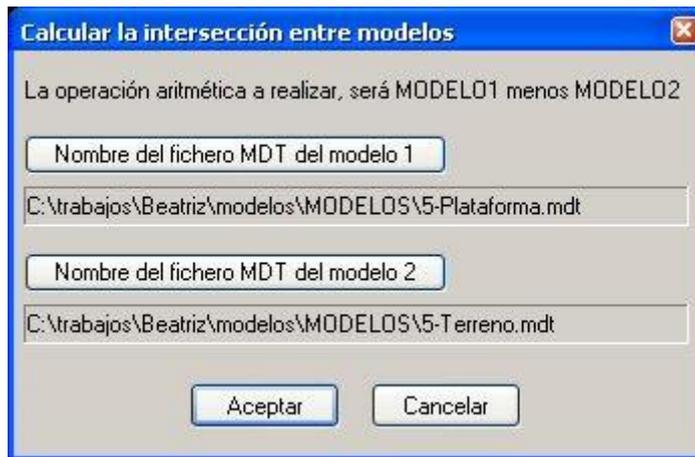
Y el programa nos calcula un modelo digital con las intersecciones entre los modelos y nos da el volumen correspondiente entre los mismos
